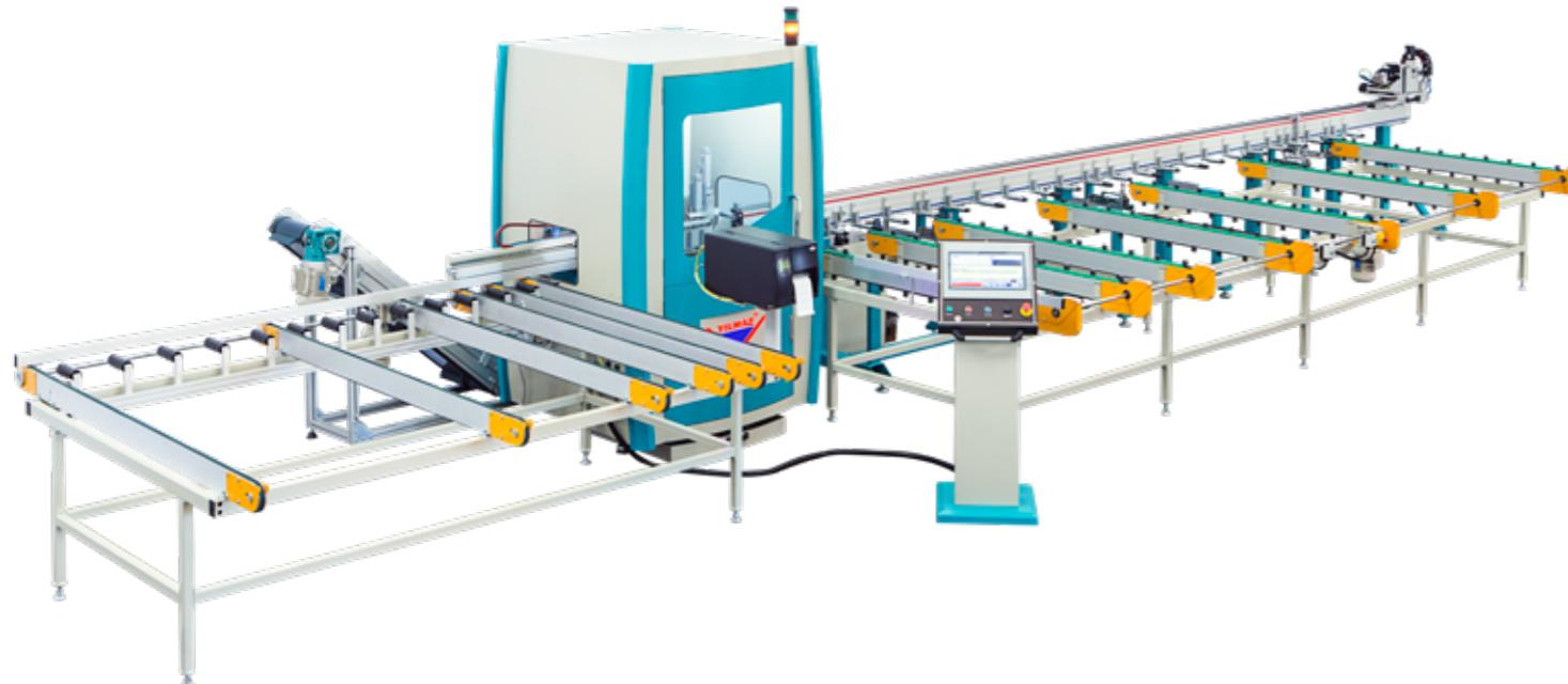
Alüminyum profillerin CNC kontrollü motorlar vasıtası ile boy kesme işlemlerini yapmak için tasarlanmıştır. Operatör besleme konveyörüne 10 adet profil koyarak hattı besleyebilmektedir.
